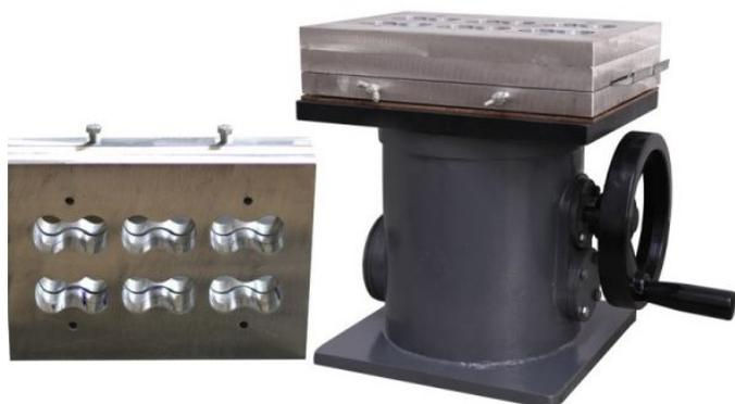
Прототип песка из смолы Sah подходит для приготовления стандартных образцов самотвердеющего песка из смолы при сжатии и растяжении.
