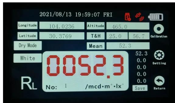
Маркировочный ретрорефлектометр R6116 представляет собой переносной измерительный прибор на месте, используемый для измерения светоотражающей характеристики дорожной разметки. Прибор типа R6116 предназначен для имитации яркости дорожной разметки, которая может быть видна водителю при освещении автотранспортных средств в темное время суток, а измеряемым параметром является коэффициент светоотражающей яркости в темное время суток, а именно  $R_L$  ценность.
