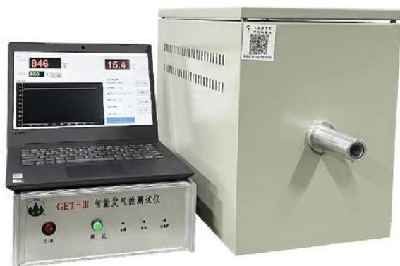
Интеллектуальная машина для тестирования производительности газа Get-III может использоваться для измерения газа и скорости движения газа в различных типах песка (сердцевины), покрытиях и других формовочных материалах, а также для измерения эффективного количества пылевидного угля в формовочной смеси.
