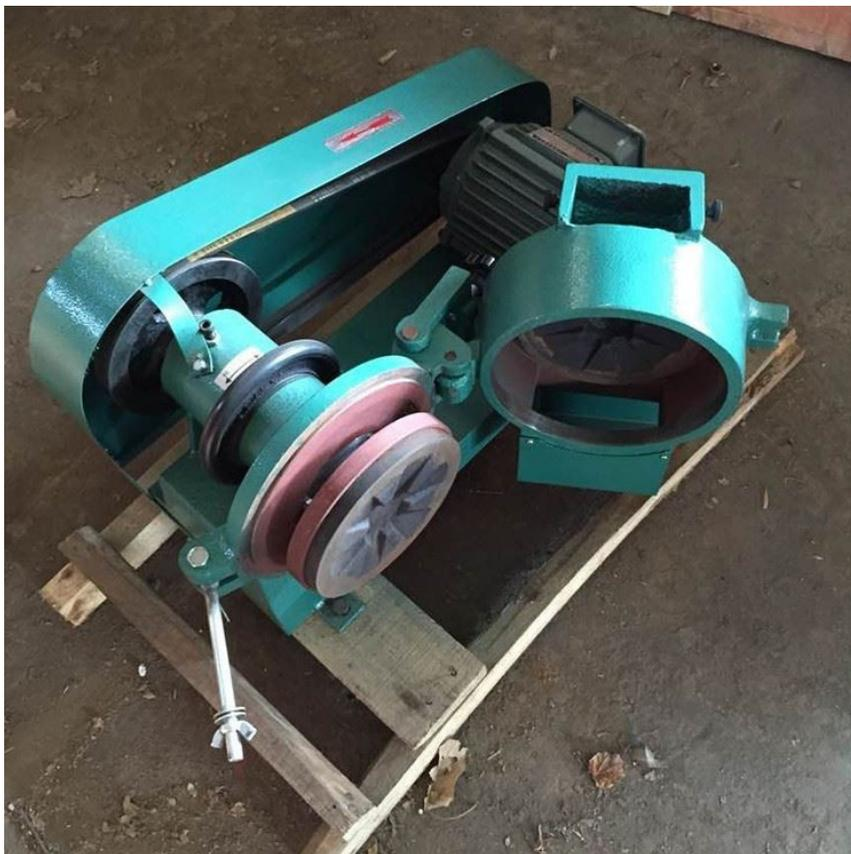
Одним из ключевых преимуществ дисковой дробилки серии Lab XPF является ее высокая эффективность при дроблении материалов. Уникальная конструкция диска и механизм регулировки скорости обеспечивают точное и эффективное дробление с минимальным уровнем шума и вибрации. Эта функция позволяет работать более эффективно, экономя драгоценное время и ресурсы.
