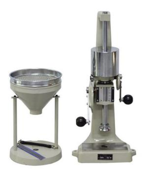
Ударный тестер Sac + измеритель песчаных инжекторов используется для приготовления различных стандартных образцов и определения плотности, необходимой для испытания физических свойств литого песка (глинистого песка).
