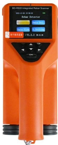
Встроенный детектор арматуры представляет собой портативный прибор неразрушающего контроля, который может быть использован для проверки качества строительства железобетонных конструкций. Он может измерять положение арматуры, толщину защитного слоя арматуры и диаметр арматуры на поверхности бетона. Кроме того, можно также определить положение магнитного тела и токопроводящего тела внутри бетонной конструкции, например, кабеля в стене, водопроводной трубы и т. д.
