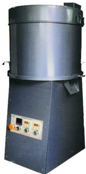
Смеситель для песка с СВЧ-покрытием используется для смешивания образцов песка с покрытием с функциями сохранения тепла, охлаждения и перемешивания, быстрого перемешивания, равномерного нанесения покрытия.
