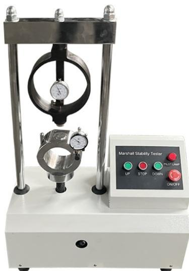
Стабилизационная машина Маршалла используется для определения нагрузок и значений расхода битумных смесей. Ручная измерительная система состоит из нагрузочного кольца грузоподъемностью 50 кН и стрелочного калибра 0,01 мм с ходом 25 мм.
