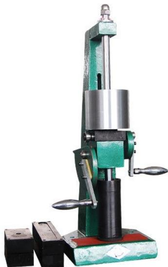
Эта машина используется для тестирования всех видов стандартных образцов, необходимых для определения физических свойств формовочной смеси для литья, и для измерения плотности формовочной смеси.
