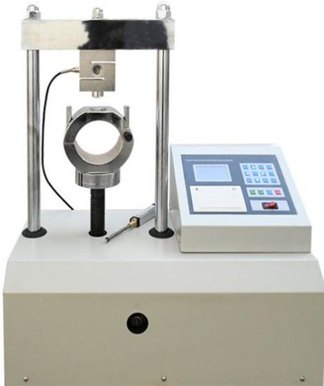
Тестер устойчивости Marshall подходит для измерения термической стабильности и сопротивления пластической деформации асфальтобетонной смеси - стабильности и величины текучести. Обеспечьте точную основу для проектирования соотношения составов асфальтобетонной смеси.
