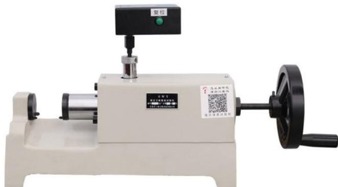
Используется для измерения сопротивления сжатию формовочного (стержневого) песка при комнатной температуре.
