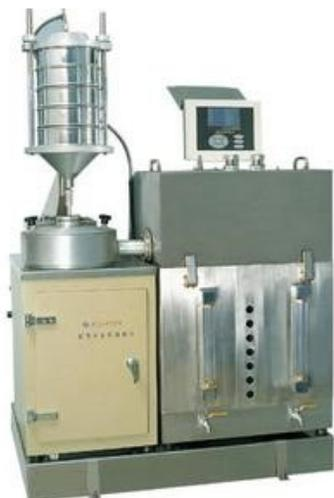
Этот аппарат объединяет в себе экстракцию асфальта и регенерацию растворителя, таким образом, он может использовать растворитель в замкнутом контуре, конструкция «высокая скорость-низкая скорость-высокая скорость» обеспечивает более безопасный сбор мелкодисперсного минерального порошка и обеспечивает более надежные результаты испытаний.
