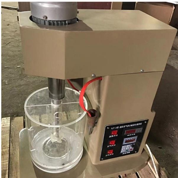
Наш реактор оснащен цифровым дисплеем, который позволяет легко контролировать температуру и скорость смешивания. Благодаря диапазону температур от 0 до 100 градусов Цельсия наш реактор подходит для широкого спектра химических экспериментов. Кроме того, мы разработали наш реактор с регулируемой скоростью перемешивания, что позволяет настроить скорость перемешивания в соответствии с вашими потребностями.
