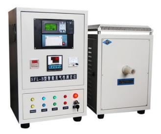
Этот прибор широко используется для измерения газообразования различных песчаных покрытий и других форм и может измерять эффективное содержание угольного порошка в песке.
