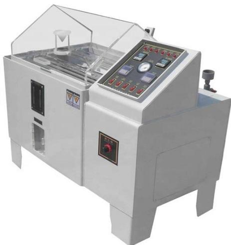
Испытательная машина в солевом тумане может определять коррозионную стойкость металлического железа или неорганической пленки металла железа или испытания на органическую пленку, такие как: гальваника, обработка анода, конверсионное покрытие, покраска и т. Д.
