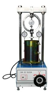
Калифорнийский тестер коэффициента несущей способности (CBR) используется для проверки коэффициента несущей способности различных грунтовых и дорожных базовых материалов, а также базовых материалов после изготовления деталей в указанном испытательном цилиндре.
