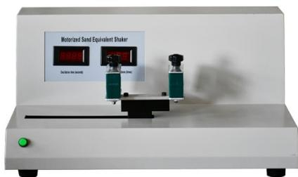
Этот инструмент подходит для асфальтобетонных смесей и цементобетона. Он использует природный песок, каменную крошку, а максимальный размер частиц его заполнителя не превышает 4,75 мм для определения содержания связного грунта или примесей в мелком заполнителе для оценки чистоты заполнителя.
