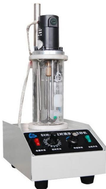
Эта машина используется для определения процентного содержания грязи в образцах песка. Ее конструкция состоит из корпуса, двигателя, вала перемешивания, дроссельной заслонки, стакана для промывки песка, таймера и так далее. Особенности этой машины: установлена новая перемешивающая лопасть, благодаря которой песок в образце песка нелегко разбить, а измеренное содержание грязи является правильным.
