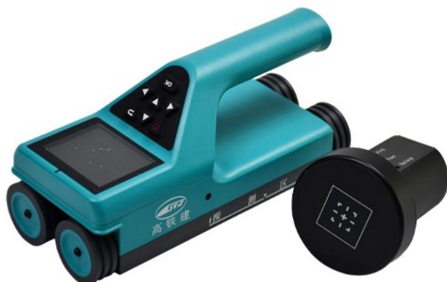
Встроенный напольный толщиномер L800 - это портативный неразрушающий прибор для измерения толщины бетона или других неферромагнитных сред. При использовании передающий и приемный зонды размещаются на двух относительных испытательных поверхностях бетона соответственно для передачи и приема электромагнитных сигналов, и прибор подключается в соответствии с соединением. Уровень полученного сигнала используется для измерения толщины бетона.
