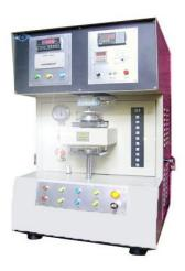
Этот прибор используется для определения прочности формовочного песка на растяжение в горячем и влажном состоянии, прочности при растяжении во влажном состоянии при постоянной температуре и определения качества бентонита и другого сырья, то есть для оценки эффективности защиты песка от зажима основными средствами обнаружения.
