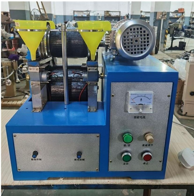
Одной из ключевых особенностей высокоинтенсивного роликового магнитного сепаратора является его способность генерировать сильное магнитное поле. Эта особенность позволяет продукту эффективно извлекать металлические примеси из обрабатываемого продукта. Кроме того, конструкция магнитного ролика высокоинтенсивного роликового магнитного сепаратора делает его идеальным для широкого спектра применений.
