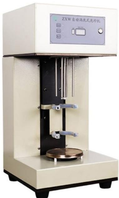
Автоматическая машина для промывки песка с вихревой промывкой ZXW оснащена передовым высокоскоростным встроенным компьютером SoC, цифровым датчиком температуры, светодиодным дисплеем высокой яркости и другими оригинальными компонентами. Весь процесс промывки песка может быть завершен автоматически без участия руководства. Она широко используется для определения содержания грязи и зольности в литейном песке.
