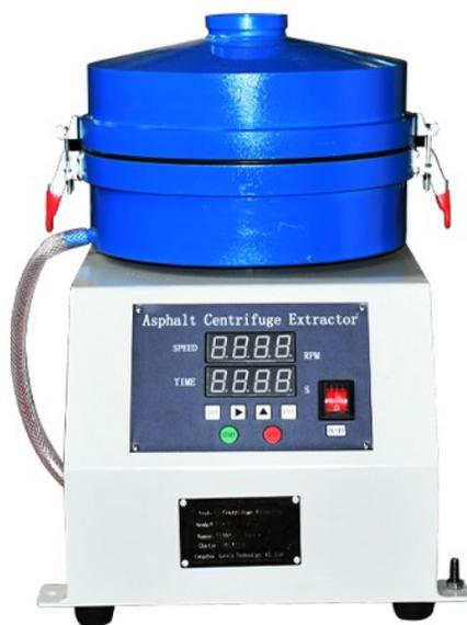
Этот прибор в основном используется для проверки содержания асфальта в асфальтобетонной смеси (метод центробежной сепарации) и для определения расхода асфальта во время строительства дорожного покрытия из горячей асфальтобетонной смеси с горячим покрытием для оценки качества продукции смесительной установки.
