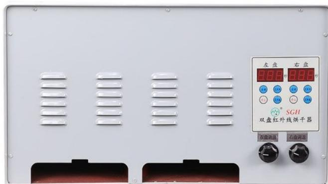
Двухдисксовая инфракрасная сушилка в основном используется для определения содержания воды в исходном (стержневом, типовом) песке для быстрой сушки. Использование тепловой энергии излучения инфракрасной лампочки приводит к быстрому испарению образца воды, а затем взвешиванию на весах, вычислению процентного содержания воды в образце.
