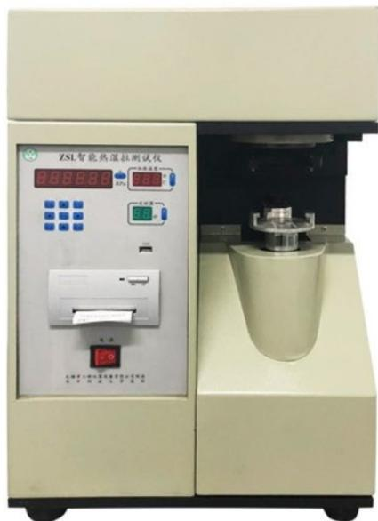
Он используется для проверки прочности на растяжение при горячей и влажной обработке и прочности на растяжение при постоянной температуре формовочного песка при влажной обработке, а также для определения качества сырья, такого как бентонит, и способности формовочного песка предотвращать зажим. С хранением данных и функцией печати выходных данных.
