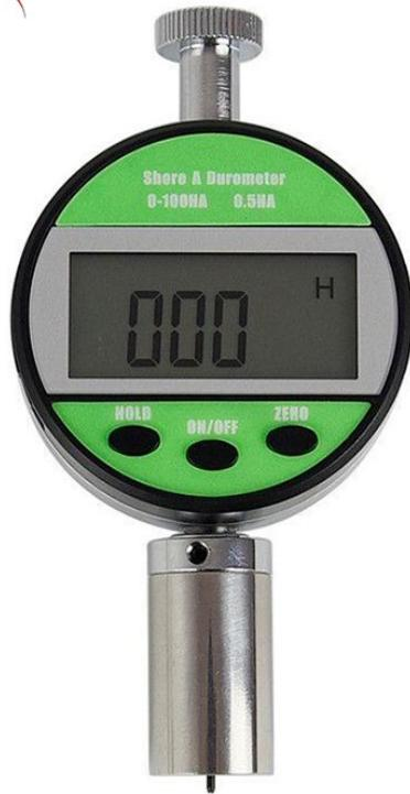
Цифровой твердомер резины Шора представляет собой прибор для измерения вулканизированных резиновых и пластиковых изделий. Этот аппарат имеет три модели типа А, типа С и типа D. Типы А и D соответственно применимы для испытаний материалов низкой и средней твердости, а также материалов высокой твердости.
