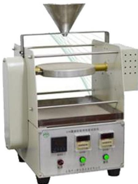
Тестер производительности зачистки песка с покрытием Stk в основном используется для определения эффективности отслаивания песка с покрытием, он состоит из нагревательной пластины, регулятора температуры, песчаной пластины, таймера и т.д., В приборе используется интеллектуальный регулятор температуры с ПИД-регулированием, обеспечивающий стабильность температуры нагревательной пластины.
