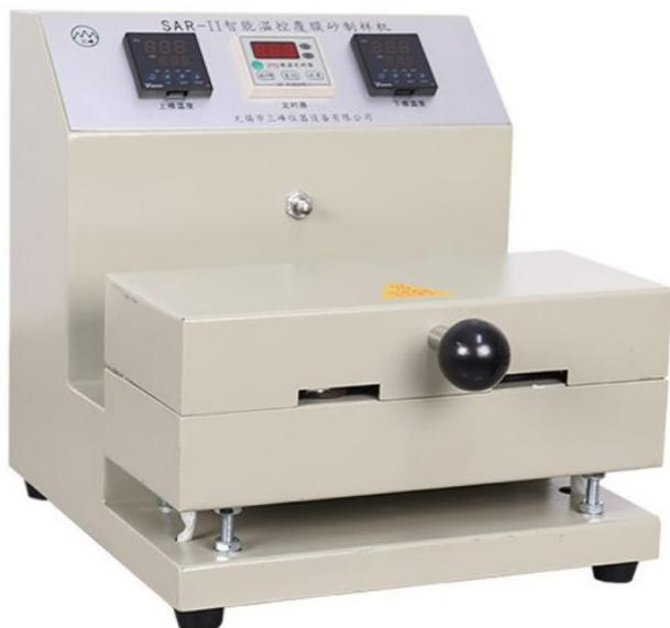
Он подходит для получения стандартных образцов на изгиб и растяжение из всех видов песка с покрытием.
