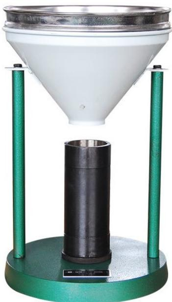
Песчаный инжектор - это простой экспериментальный инструмент, который в качестве инструмента для разрыхления песка обеспечивает равномерные характеристики подготовленного образца песка. Его можно использовать в сочетании с прототипом SAC или гидравлическим прототипом для обеспечения загрузки формовочного песка в цилиндр для образцов прототипа SAC с заданной высоты, чтобы точно измерить скорость уплотнения формовочного песка. Песковая форсунка состоит из корпуса, решетчатой пластины и воронки.
