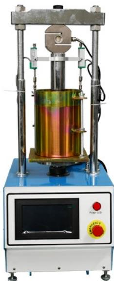
Тестер коэффициента несущей способности (CBR) используется для проверки коэффициента несущей способности различных грунтов и материалов основания и дна дорожного покрытия после изготовления тестовых образцов в предписанной пробирке.
