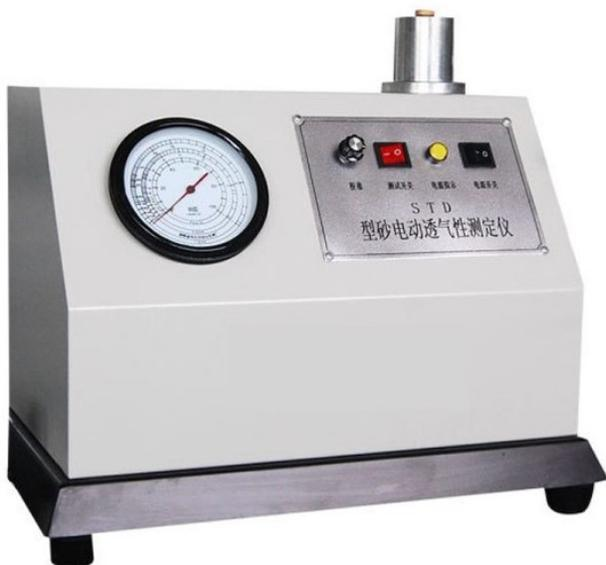
Этот прибор используется для измерения проницаемости формовочного (стержневого) песка в сухом и влажном состоянии. Прибор изготовлен высокоскоростным центробежным нагнетателем для проверки стабильного источника воздуха. Ее также можно использовать для проверки проницаемости песка в литейном цехе. Прибор отличается небольшим объемом, простой структурой, удобным управлением, высокой скоростью тестирования и красивым внешним видом.
