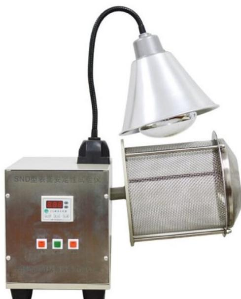
Тестер стабильности поверхности формовочного песка SAD используется для проверки стабильности поверхности различных типов песка (сердцевины)
