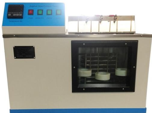
Тестер содержания асфальтового парафина, растворите дистиллированное масло, полученное путем крекинга перегонного образца, со смешанным растворителем этилового эфира и этанола, и охладите его при  $-20^{\circ}\text{C}$ , отфильтруйте осажденный воск и растворите отфильтрованный воск петролевым эфиром. Растворитель выпаривают, а затем рекристаллизуют ацетоном, осажденный воск растворяют петролевым эфиром, растворитель выпаривают из раствора, сушат и взвешивают.
