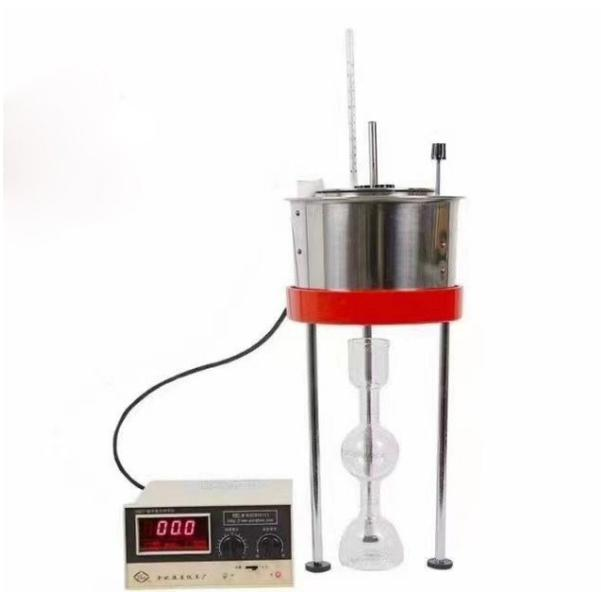
Измерьте отношение времени (секунд), вытекающего из вискозиметра Энгеля, ко времени (секундам), вытекающего из чистой воды при 20С при определенных температурных и объемных условиях, которое является вязкостью жидкости по Энгелю, а единицей измерения является градусы состояния.
