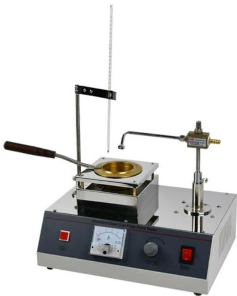
Измеритель температуры вспышки Кливленда, подходящий для измерения вязкого нефтяного пека, угольного пека и жидкого нефтяного пека с температурой вспышки выше 79 °С, для оценки безопасности строительства.
