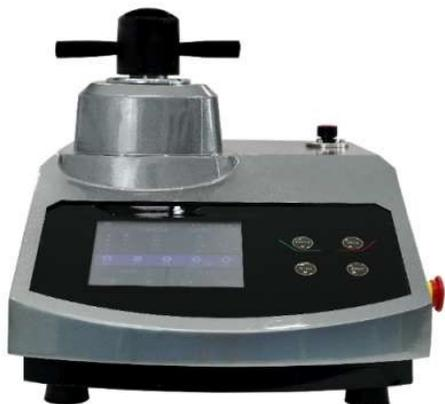
Автоматическая металлографическая машина для инкрустации образцов представляет собой многофункциональный монтажный станок с водяным охлаждением для монтажа различных образцов. Инкрустация мелких и нестандартных заготовок. После монтажа удобно выполнять шлифовальные и полировальные операции на заготовке, а также пользователям выгоднее наблюдать за структурой материала под металлографическим микроскопом.
