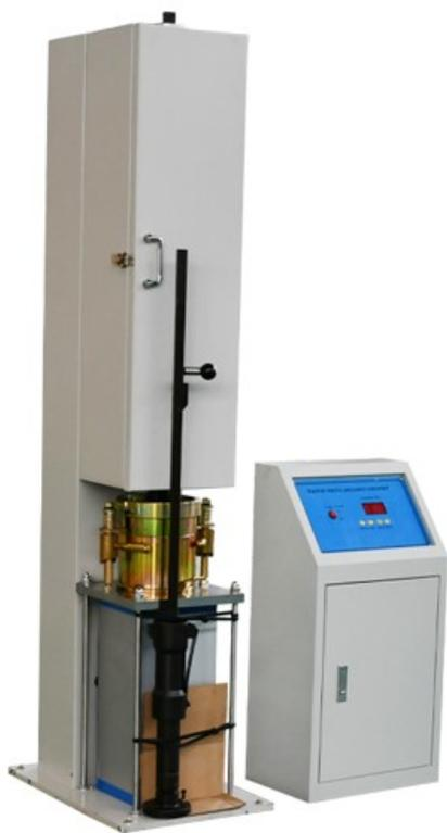
Уплотнитель Marshall - это специальный прибор для формирования образцов при испытании асфальтобетонной смеси на устойчивость по методу Маршалла. Его конструкция и производительность полностью соответствуют требованиям правил испытаний на дорогах. Прибор отличается небольшими размерами, удобством в эксплуатации, надежной работой, автоматической технологией, автоматическим уплотнением, автоматическим отключением и паузой во время работы. Подходит для лабораторных и полевых работ.
