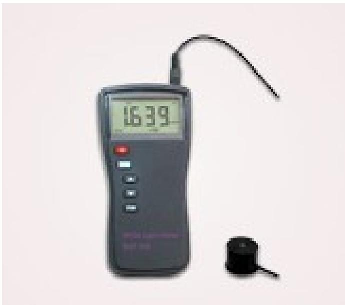
Измеритель белой освещенности - это компактный, прочный, простой в эксплуатации, многофункциональный измеритель белого света, который доказал свою высокую эффективность для измерения и калибровки источников излучения видимого света, используемых при флуоресцентном магнитопорошковом и жидкостном капиллярном неразрушающем контроле.
