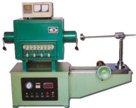
Этот прибор используется для определения прочности сцепления различных литейных покрытий в условиях высоких температур и оценки тенденции к растрескиванию посредством визуального наблюдения, также может использоваться для сравнительного анализа видеозаписи, определения физических свойств покрытия при высоких температурах, широко используется в научных исследованиях, обучении и производстве.
