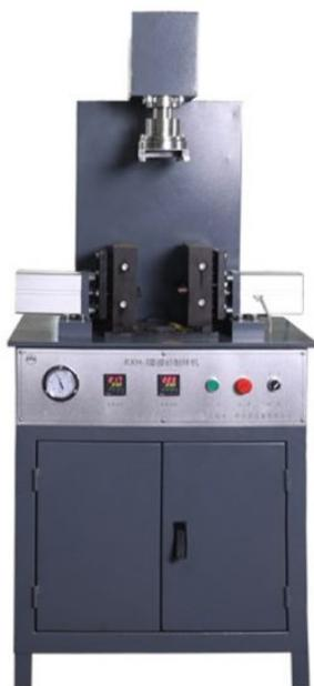
Прототип для производства песка с покрытием RXH-I - это оборудование для изготовления стержней на растяжение образца типа "8" и изгиб образца для процесса производства песка с покрытием. Прототип песка с покрытием RXH-I состоит из машины для извлечения керна, пресс-формы для образцов, электрической системы управления и так далее. Режим работы оборудования может быть полностью автоматическим. Компактность образца неизменна, а данные измерений стабильны и надежны.
