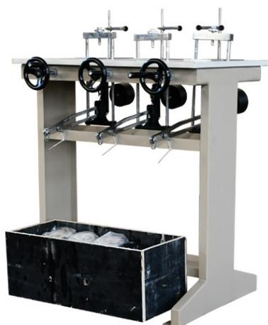
Этот продукт используется для проведения испытаний на сжатие грунта для определения взаимосвязи между деформацией грунта и давлением, коэффициентом пустот и давлением, деформацией и временем. В этом эксперименте можно рассчитать единичную осадку грунта, коэффициент и индекс сжатия, индекс отскока, модуль сжатия, коэффициент консолидации и так далее. Элементы измерения должны определяться потребностями проекта.
