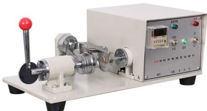
Тестер износостойкости поверхности покрытия, может использоваться для определения износостойкости поверхности краски и износостойкости влажного песка. Если износостойкость песка и краски низкая, это не только напрямую влияет на шероховатость поверхности отливки, но и легко приводит к образованию песка, засыпки песком и других дефектов. Следовательно, износостойкость покрытия и формовочной смеси следует проверять при их настройке.
