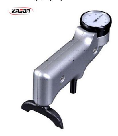
Твердомер Barcol - это твердомер вдавливающегося типа. Это быстро, просто и легко тестировать. Его можно использовать для быстрой проверки твердости алюминия и материалов из алюминиевых сплавов и соответствия американскому стандарту ASTM B648.
