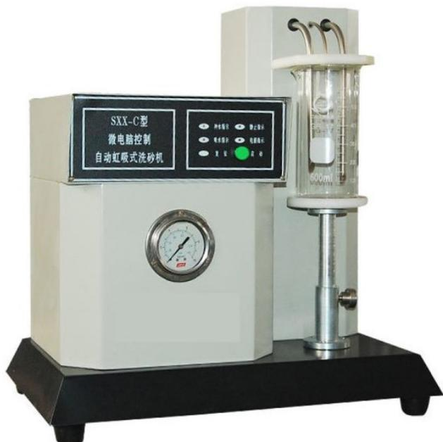
Этот прибор используется для определения процентного содержания глины в сыром песке или старом песке. Это автоматическое оборудование, управляемое микрокомпьютером в соответствии с программой ручного отсеивания. Прибор проще по конструкции, удобен в эксплуатации и стабилен по результатам испытаний на основе оригинального прибора SXX.
