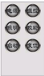
Кнопка питания Включает питание каждого устройства Кнопка термостата для включения отопления Кнопка освещения Включить освещение Кнопка резинового колеса заставляет резиновое колесо двигаться кнопка запуска кнопка запуска теста кнопка сброса сброс теста Область настройки функции
