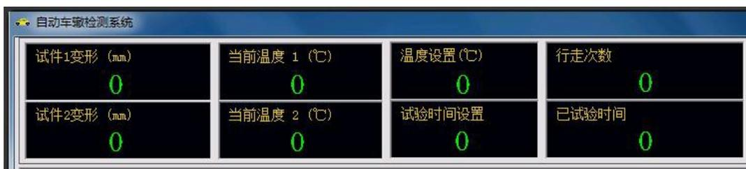
Отображение текущих данных в режиме реального времени, включая текущую настройку температуры деформации текущую температуру время прохождения теста время настройки теста
