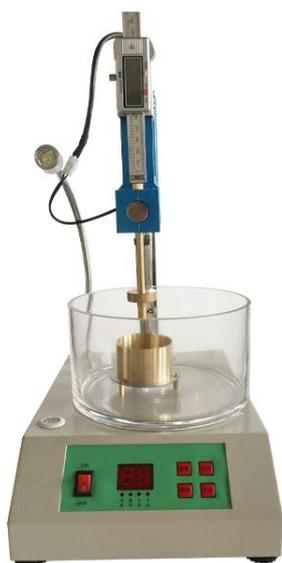
Этот инструмент в основном используется для проникновения в вязкий дорожный нефтяной асфальт, жидкую нефть, асфальт и асфальтовые материалы после испытаний на дистилляцию или эмульгирование.
