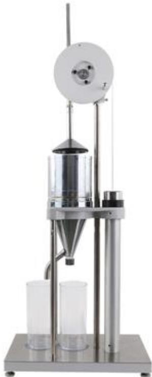
Прибор применим для тестирования всех видов жидкой суспензированной целлюлозы, которые менее 100°SR — Шоппер-Риглер. Он может экономично использовать материал с ручным управлением и легко работать. Его параметры и производительность соответствуют стандартам QB/T1054-98, GB/T3332-1982 и ISO5267/1.
